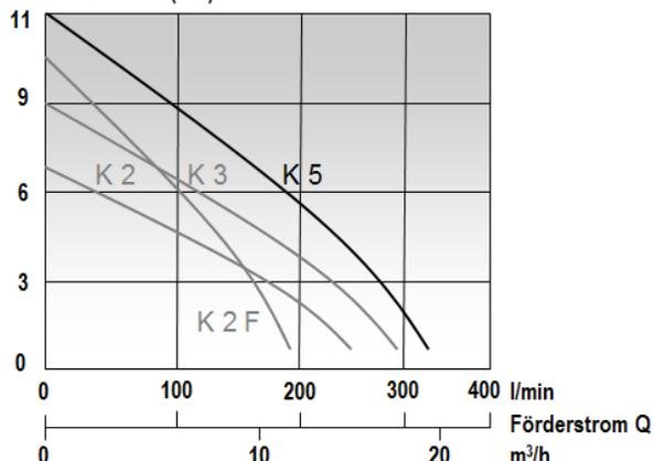
Q l/min. bei H m (Wassersäule), gültig für  $\rho = 1 \text{ kg/dm}^3$  und kinematische Viskosität  $\eta = 1 \text{ mm}^2/\text{s}$ .
